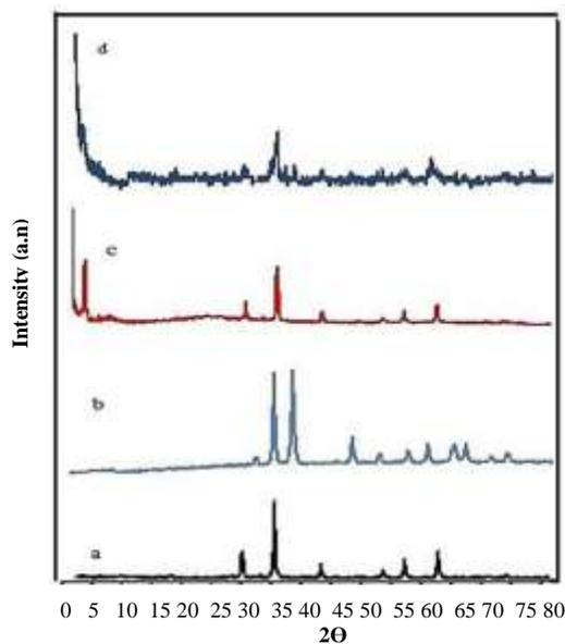
**Figure 1.** XRD patterns for  $\text{Fe}_3\text{O}_4$  (a), CuO (b),  $\text{Fe}_3\text{O}_4@\text{MCM41}$  (c) and  $\text{Fe}_3\text{O}_4@\text{MCM41}/\text{CuO}$  nanoparticles (d).
