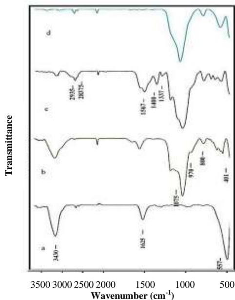
**Figure 2.** FTIR spectra of the  $\text{Fe}_3\text{O}_4$  (a),  $\text{Fe}_3\text{O}_4@\text{MCM41}$  (b),  $\text{Fe}_3\text{O}_4@\text{MCM41}-\text{NH}_2$  (c),  $\text{Fe}_3\text{O}_4@\text{MCM41}/\text{CuO}$  (d) nanocomposite.
